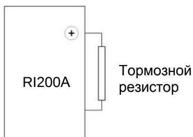
Рис. 12-5. Схема подключения тормозного резистора
