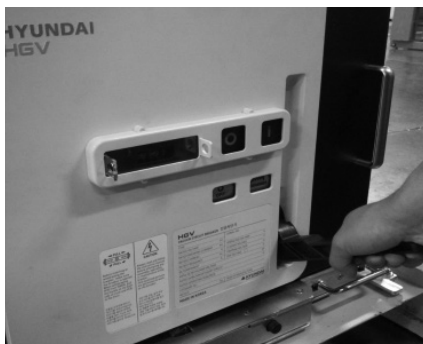
Fig. 3-3 Charging the spring / Рис. 3-3 Ввод пружины
