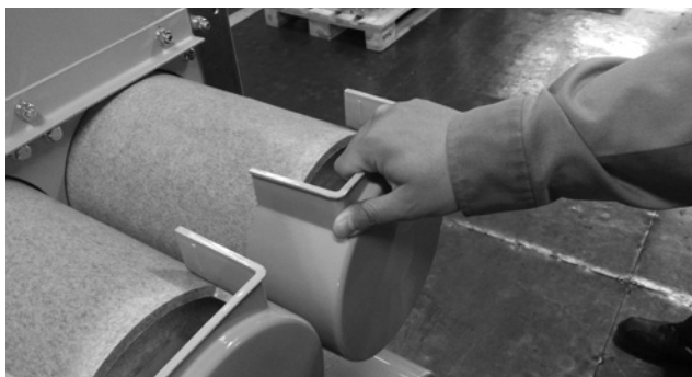
Fig. 3-2 Bushing cover inspection / Рис. 3-2 Проверка крышки втулки
