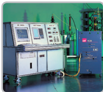
Проверка характеристик вакуумного автоматического выключателя
