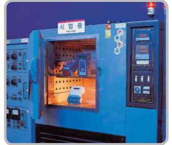
Испытание непрерывным воздействием высокой температуры
