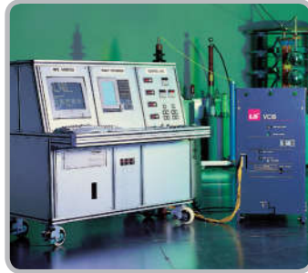
Проверка характеристик вакуумного автоматического выключателя
