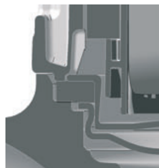
Рис. 48 Чертеж в разрезе с изображением принципа закупоривания уплотнения
