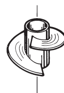
Рис. 6 Шнек на входе
