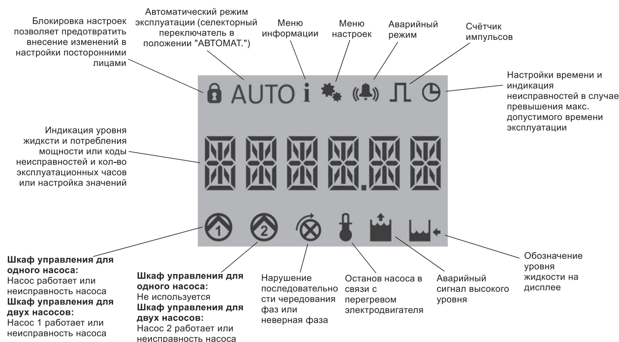
Рис. 114 Панель управления шкафов для установок с одним насосом
