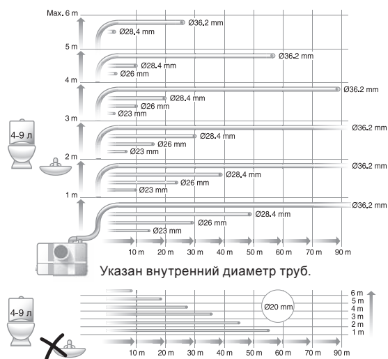
Рис. 55 Максимальная длина вертикальных и горизонтальных сливных труб
