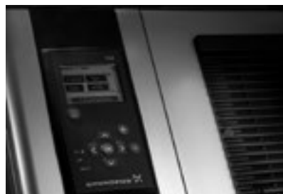
Рис. 29 Панель управления Grundfos CUE
