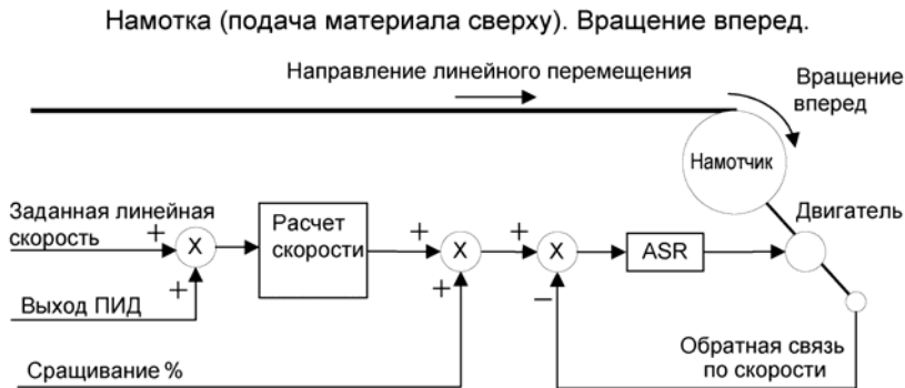
Рис 1. Намотка рулона при подаче материала сверху.
